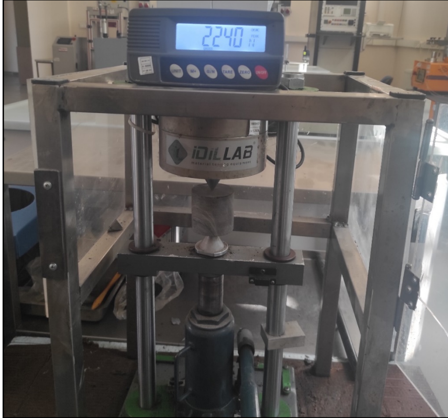
Şekil 20- Nokta yükü dayanım indeksi testi uygulaması
