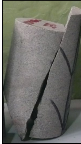
Şekil 16- Tek eksenli basınç dayanımı tayini numunesi (deney sonrası)
