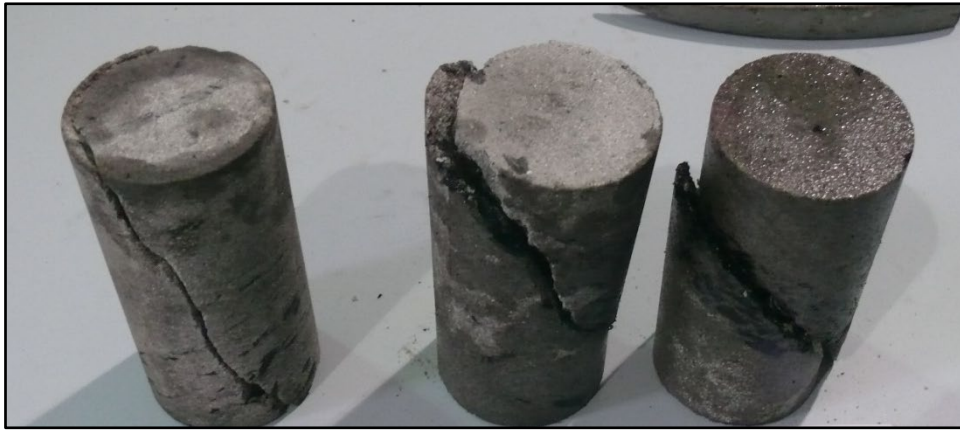
Şekil 19- Üç eksenli basınç testi numunesi (deney sonrası)
