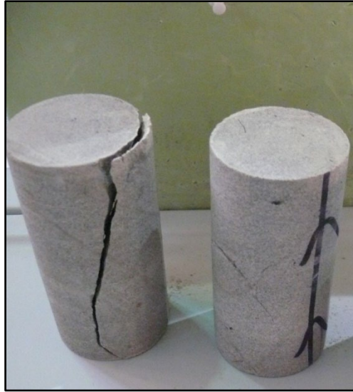
Şekil 17- Deformasyon testi numunesi (deney sonrası)
