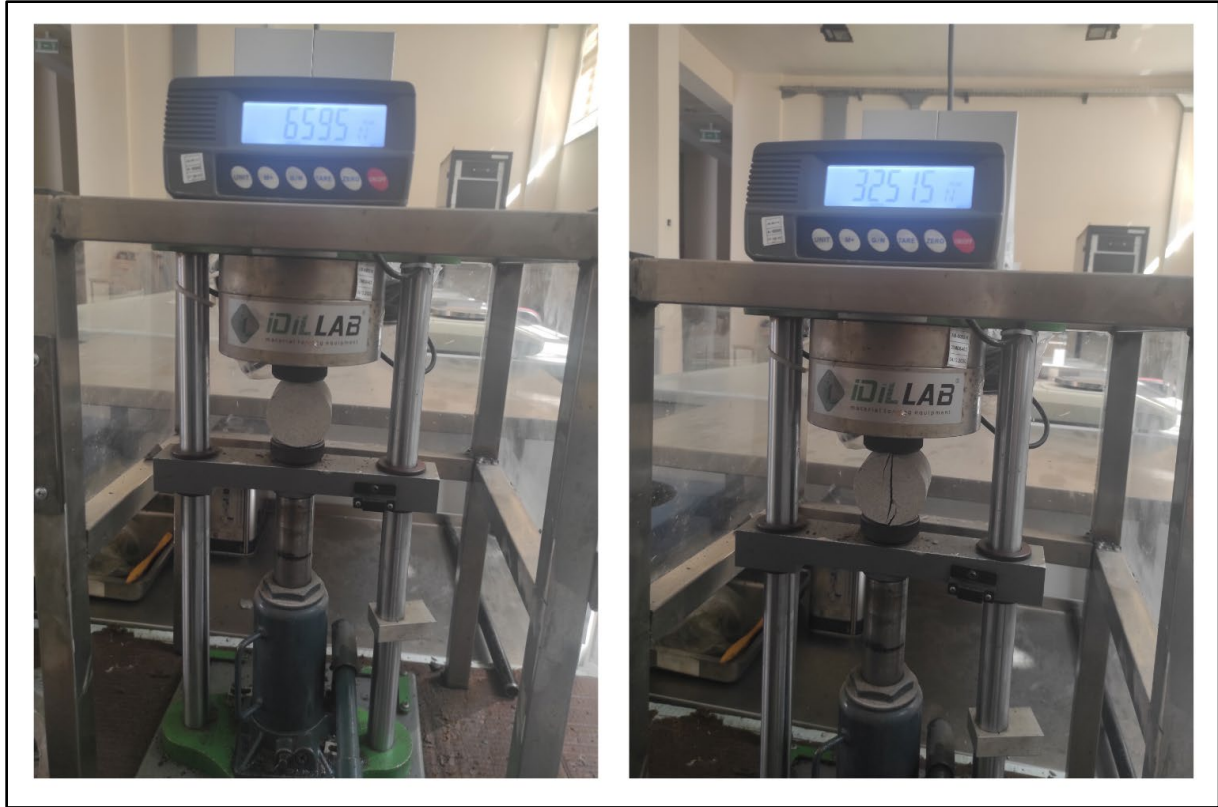
Şekil 21- Çekme dayanımı tayini uygulaması
